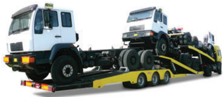
■ 3 車軸 トラック運搬用特殊トレーラ
