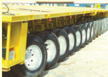
■ 3 車軸 トラック運搬用特殊トレーラ
